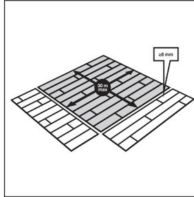
Räume deren Länge und Breite unter 30 m lang sind, können in einer Fläche verlegt werden. Größere Flächen müssen mittels Bewegungsfugen in mehrere kleine Flächen unterteilt werden. Bewegungsfugen der Unterbodenkonstruktionen müssen immer in den Oberbelag übernommen werden. Stellen Sie sicher, dass auch zu den Bewegungsprofilen ein Abstand von 8 mm eingehalten wird.
