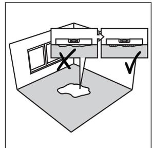
Alle Untergründe müssen trocken, tragfähig, eben und sauber sein. Jegliche Löcher und Unebenheiten müssen durch Nivellierungsmasse ausgeglichen werden. Neue Estriche müssen durchgetrocknet (mindestens 1 Woche pro cm) und ausgehärtet sein.
