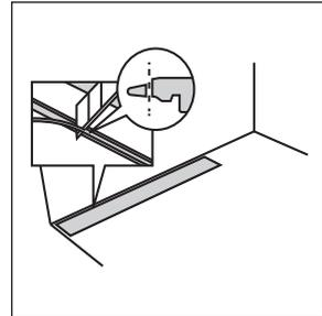
Aufgrund der materialtypischen Eigenschaften des Designbodens, ist es notwendig eine Bewegungsfuge von 8 mm zwischen Diele und Wand oder anderen feststehenden Gebäudeteilen einzuhalten. Entfernen Sie bei der ersten Reihe die Feder, um die Bewegungsfuge präziser einhalten zu können.
