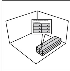
Überprüfen Sie die Menge, Farbe und Produktionsnummern des Materials bevor Sie mit der Verlegung beginnen. Verlegen Sie in einer Fläche nur Ware mit der gleichen Produktionsnummer, um größere Farbvariationen zu vermeiden.
