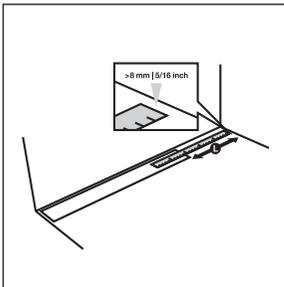
Um eine Reihe abzuschließen, müssen meistens die Dielen gekürzt werden. Messen Sie den Abstand zur Wand und ziehen die notwendigen 8 mm für die Bewegungsfuge ab. Notieren Sie das Resultat.
