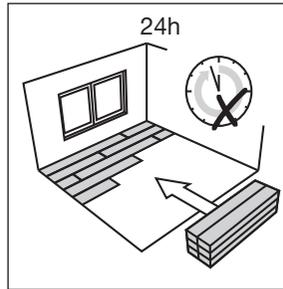
Wenn der Unterboden bereits vorbereitet ist, kann man ohne weitere Akklimatisierung des Bodens sofort mit der Verlegung beginnen.
