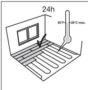
Der Designboden kann in Räumen mit einer Fussbodenheizung verlegt werden. Die Oberflächentemperatur darf 28°C nicht übersteigen.
