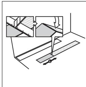
Nehmen Sie eine weitere Diele und markieren die Länge, die abgeschnitten werden soll. Zum Schneiden von Designbodendielen benutzen Sie ein Cuttermesser und ritzen mehrfach die Oberfläche ein. Danach kann die Diele sauber gebrochen werden.
