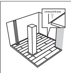
Halten Sie grundsätzlich die 8 mm Bewegungsfuge der Dielen zu allen festen Bauteilen im Raum ein. Dies gilt für Wände, Türailbungen, Säulen, Rohrleitungen etc.
