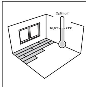
Die optimale Raumtemperatur für die Verlegung sind 21°C.
